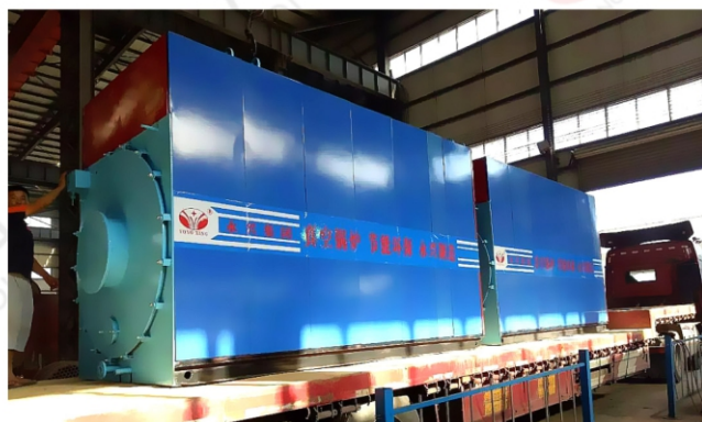
2017.03 西安唐城医院2台2.8MW真空热水锅炉
