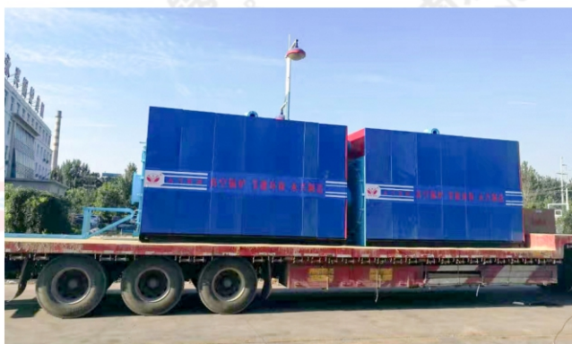
2017.04 天津科林自行车厂1.05MW真空热水锅炉
